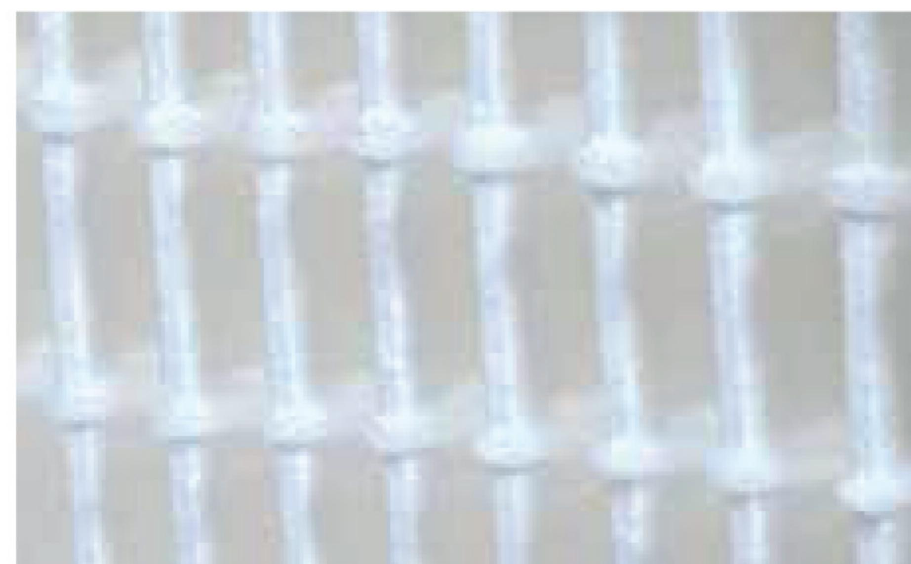
La tecnología E-Pleat moldea el medio filtrante en una serie de canales preformados que dirigen el aire de manera estable a través del filtro, lo que permite una carga más uniforme y una utilización completa de la media filtrante.
